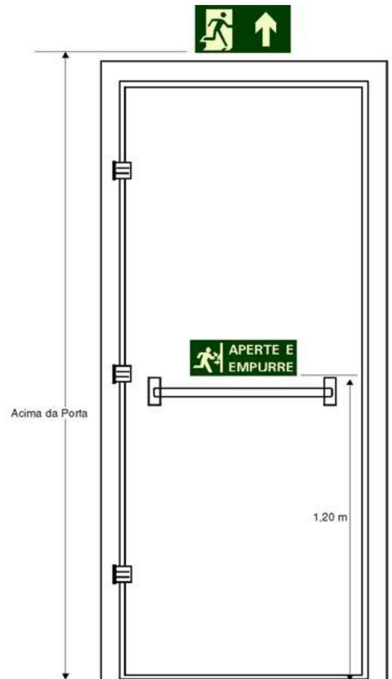
Figura 5 – Sinalização de portas com barras antipânico. **OBS.:** Nesta edificação só existe uma porta com barra antipânico.
